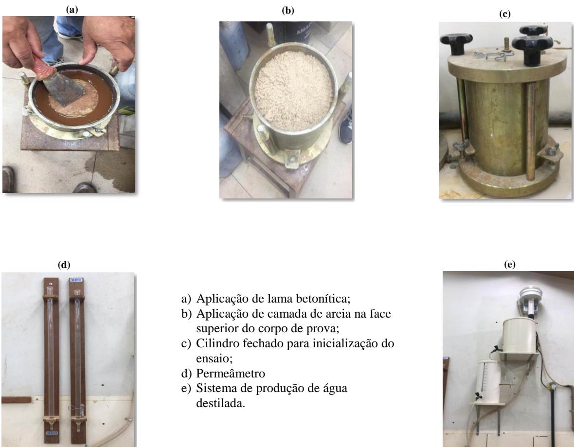
Figura 62. Preparação e equipamentos para ensaio de permeabilidade do LAPAV/FT-UFAM
