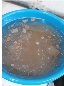
Figura 61. Demonstração de comportamento de corpos de prova com teor de emulsão 2% submetidos à imersão em água.
