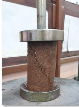
Figura 60. Comportamento de ruptura de corpos de prova submetidos ao ensaio de RCS
